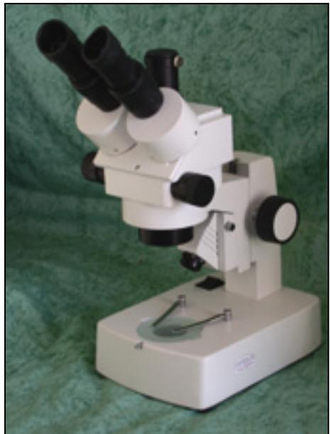
**A sinistra: microscopio biologico per acqua e preparati trasparenti; a destra: un modello stereo per corpi opachi, minerali, insetti, ecc.**
